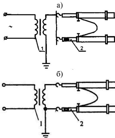
Рис. 2.2. Принципиальные схемы испытания указателя напряжения для проверки совпадения фаз по схеме согласного (а) и встречного (б) включения:
